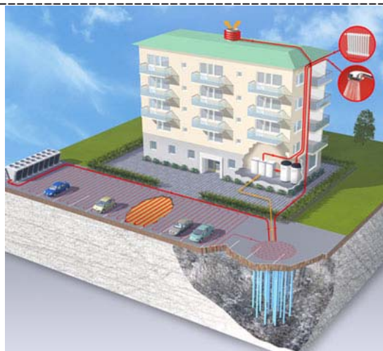
Photo 7 Una descrizione generale del sistema di accumulo energetico costituito da uno strato di pozzi, dove l'energia estratta può essere riutilizzata. La tecnologia di stoccaggio fornisce la capacità di controllare i flussi termici di scarto con differenti exergies (qualità Energia) in diverse zone di stoccaggio. Il caldo o il freddo possono essere ottenuti allo stesso tempo.
